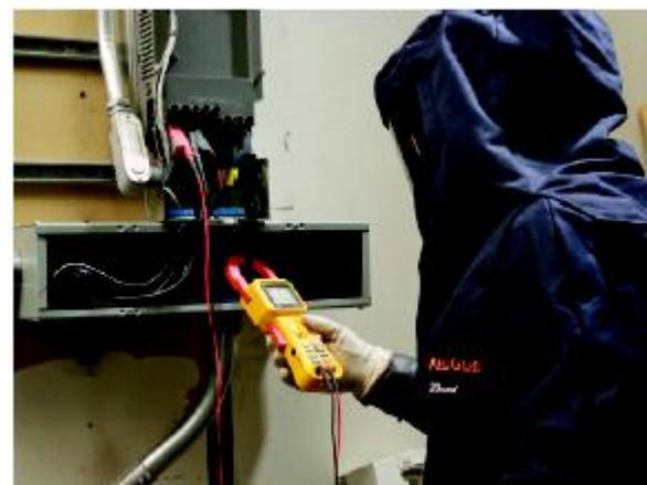
Swanson 负责大量变频器驱动器以及所有 UPS。他说，Fluke 345 可以帮助他保持电机驱动器正常运转，并防止这些驱动器给设施的其余部件带来问题。“Fluke 345 上的示波器功能可以让我查看波形，并显示异常现象。” Swanson 说。“我可以检测到电源线路上可能发生的任何类型的失真，或者由驱动器产生的并返回到电网的谐波。我需要知道驱动器是否正在对其他设备产生有害影响。”带有低通滤波器的 345 可以不受干扰地精确读取变频驱动器输出。
